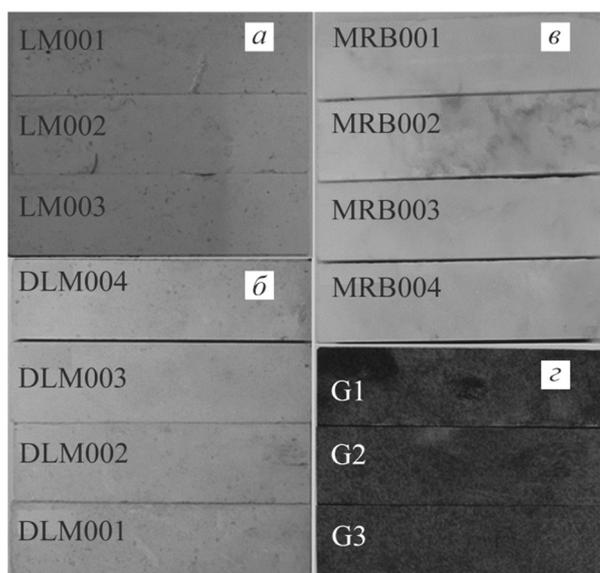
Рис. 2. Образцы известняка (а), доломита (б), мрамора (в) и габбро (з)
