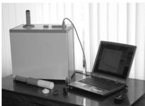
Рис. 3. Внешний вид ЯМР-релаксометра “МСТ-05”
