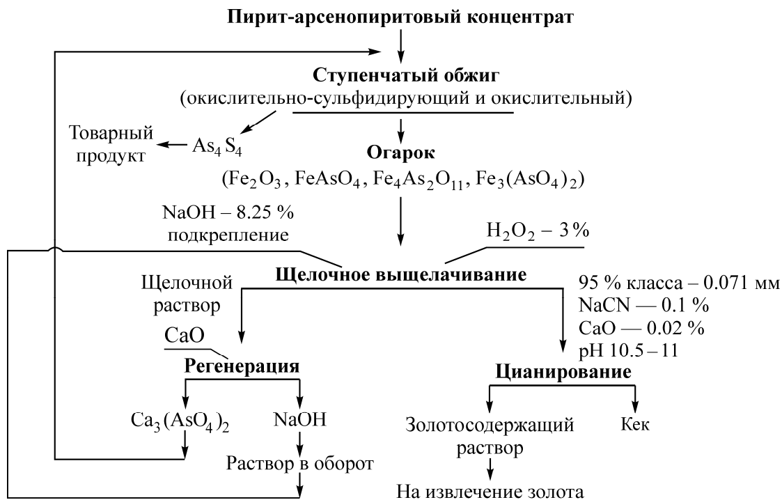
Рис. 4. Принципиальная схема извлечения золота и мышьяка из упорных пирит-арсенопиритовых концентратов
