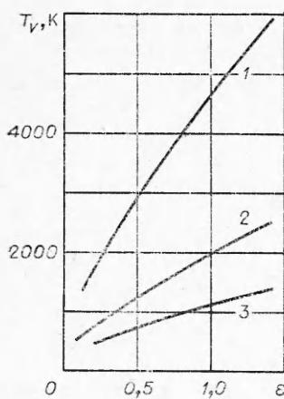
Рис. 3. Зависимость колебательной температуры от удельной поглощенной энергии (в квантах излучения НГ-лазера на молекулу  $N_2O$ ).
