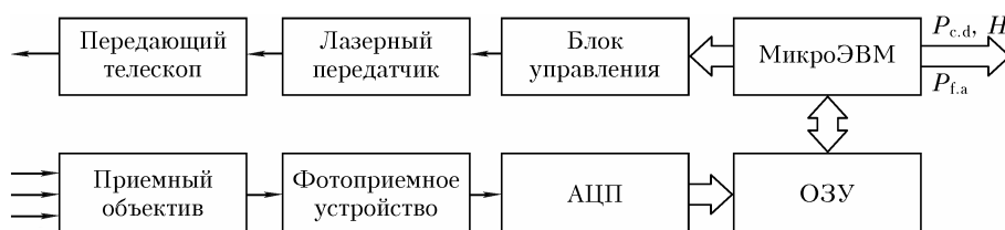
Рис. 1. Структурная схема ЛД с цифровой обработкой пачечного сигнала: черные стрелки — аналоговые сигналы; белые — цифровые
