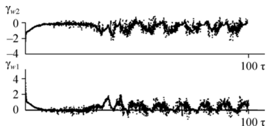
Рис. 4. Зависимость интенсивностей \gamma_{w1}, \gamma_{w2} сходящихся вихрей от времени \tau для \theta = 90^\circ .
