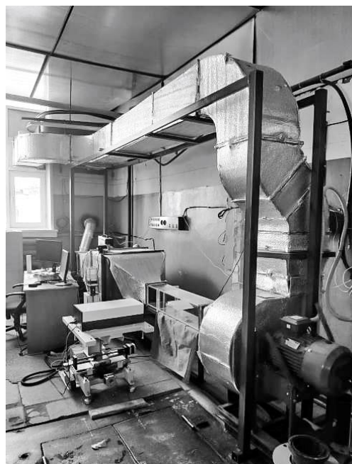
Рис. 2. Фотография климатической трубы и измерительного комплекса ЛАД-07Т для измерения профилей скорости потока.
