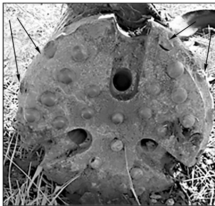
Рис. 1. Отработанное долото пневмоударника после бурения скважины на горном отводе шахты “Полысаевская”.
