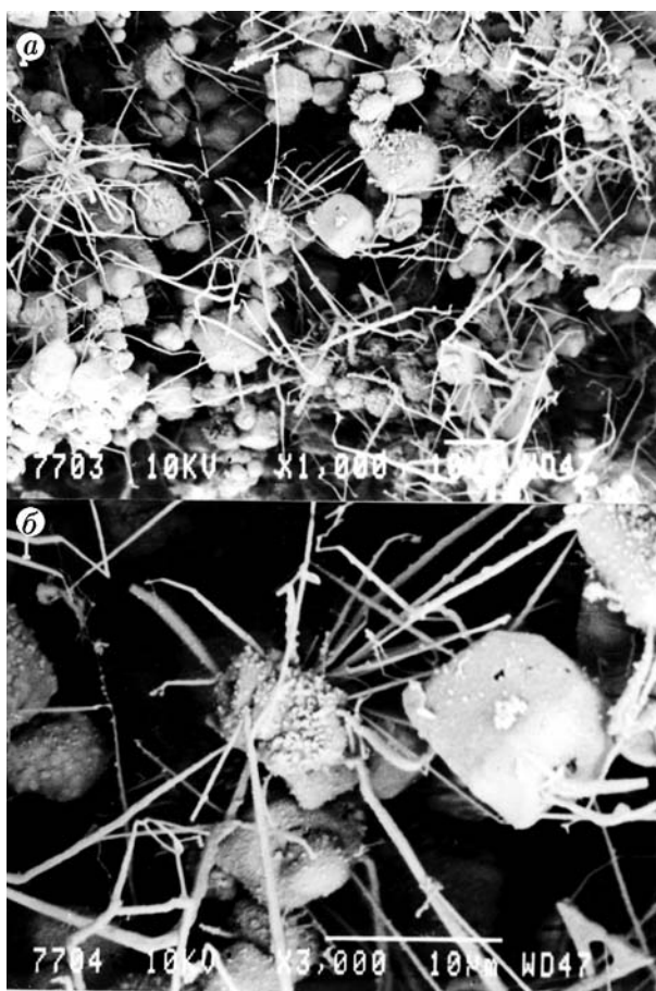
Электронно-микроскопические фотографии продуктов горения гидрида алюминия в воздухе:
