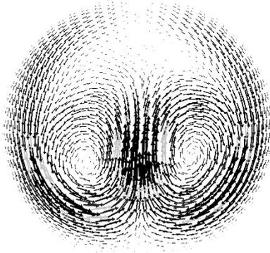
Рис. 6. Вторичные течения в ответвлении при  $x/d = 2,2$  и  $Q_1/Q = 0,5$ .
