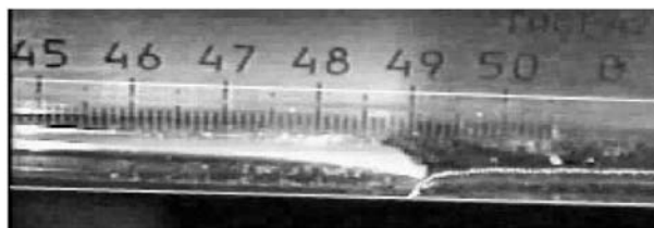
Рис. 4. Пламя над жидкостью (края трубы и жидкости выделены; расход воздуха 22 \text{ см}^3/\text{с} )
