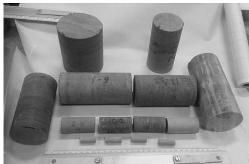
Рис. 1. Образцы алевролита  $d = 60, 30, 10$  мм
