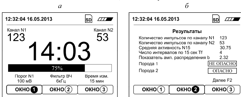
Рис. 4. Главное окно (а), отражающее процесс измерения, и окно представления результатов АЭ контроля (б) прибора “Prognoz L”
