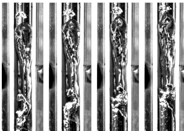
Рис. 4. Эволюция газового снаряда в трубе диаметром 20 мм со свинцово-висмутовым расплавом. T = 160^\circ\text{C} , Q_g = 700 мл/мин, время между кадрами 4,2 мс.
