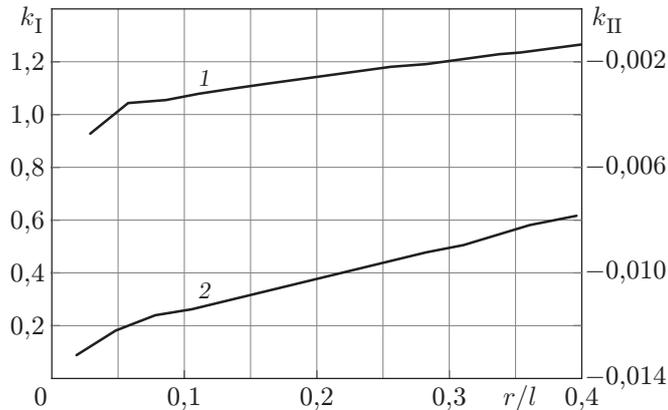
Рис. 8. Результаты расчета КИН  $k_I$  (1) и  $k_{II}$  (2) с использованием метода конечных элементов
