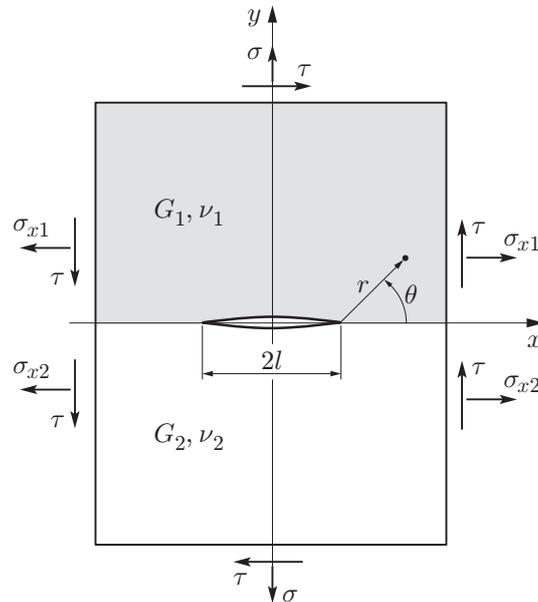
Рис. 7. Схема пластины с трещиной на границе раздела двух сред
