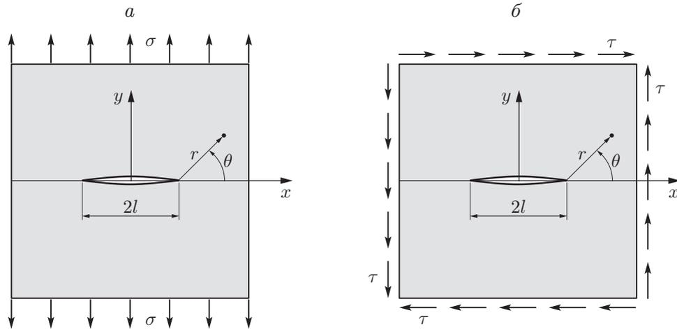
Рис. 2. Расчетные схемы плоских задач:
