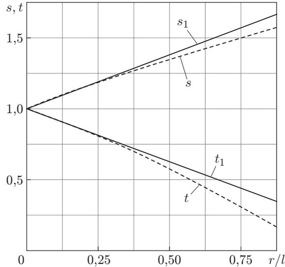
Рис. 3. Приближенное  $(s_1, t_1)$  и точное  $(s, t)$  распределения напряжений для плоской  $(s, s_1)$  и пространственной  $(t, t_1)$  задач
