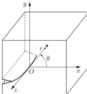
Рис. 1. Схема расположения трещины и система координат
