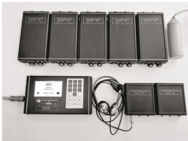
Рис. 2. Комплект шахтной сейсморазведочной станции с пятью блоками измерительными, устройствами связи и синхронизации
