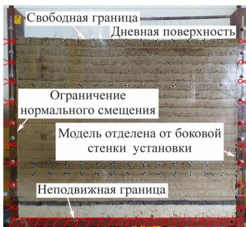
Рис. 2. Установка для имитационного моделирования
