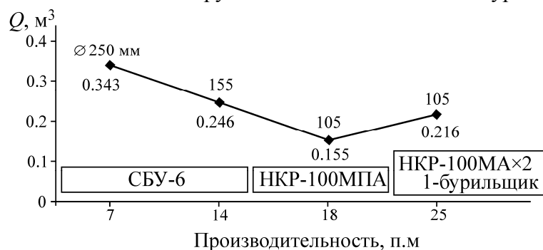
Рис. 10. Зависимость скорости объемного бурения скважин диаметром 250, 155 и 105 мм от сменной производительности станка СБУ-6 и НКР-100МПА (данные Абаканского рудника 2009–2010 гг.)
