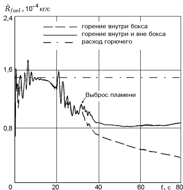
Рис. 5. Зависимость скорости выгорания от времени при \dot{m}_{fuel} = 0,15 г/с, W = 0,15 м, H = 0,1375 м
