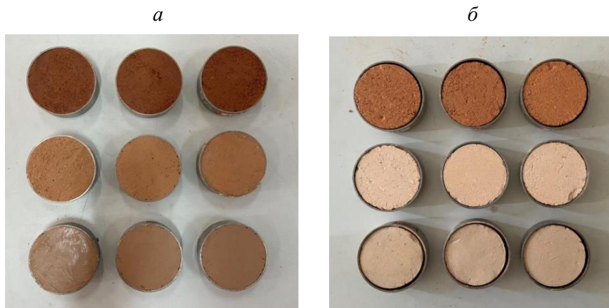
Рис. 1. Образцы грунта: до усадки (а); после усадки (б)
