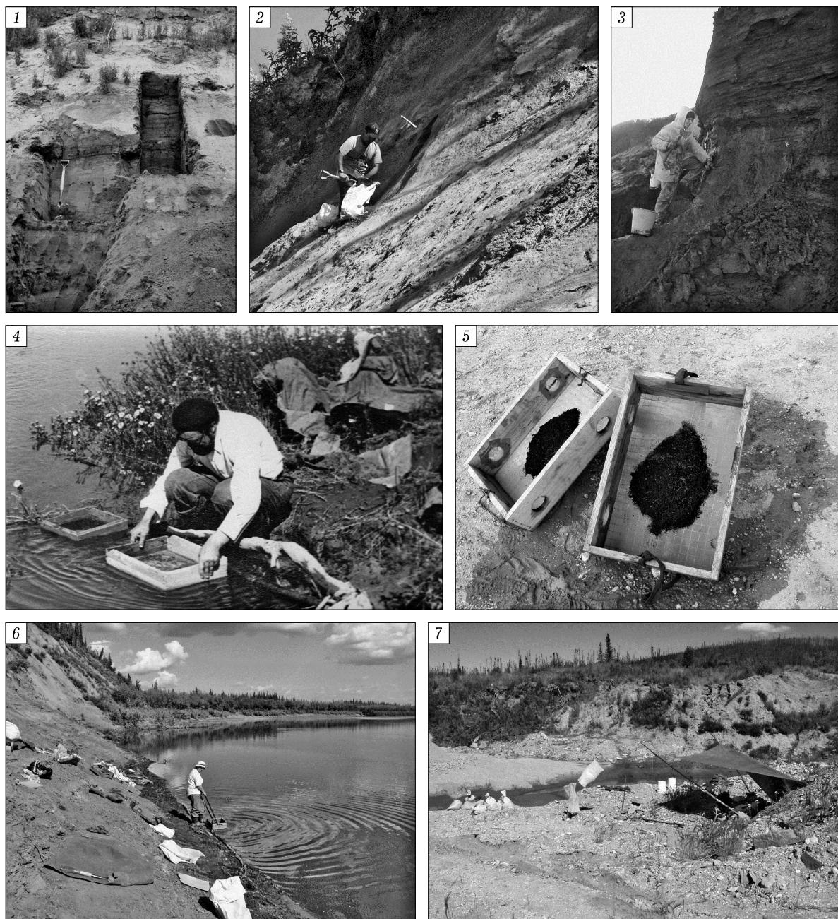
Рис. 2. Отбор образцов на макроэнтомологический анализ: 1 – расчистка разреза; 2 – отбор рыхлых отложений; 3 – отбор мерзлых отложений с помощью топора; 4 – промывка простым ситом в 1980-х гг.; 5 – образец после промывки в усовершенствованном сите; 6 – рабочее место у реки; 7 – рабочее место на карьере в жаркий день
