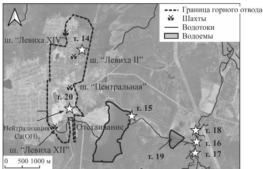
Рис. 1. Схема двухступенчатого метода очистки кислых шахтных вод и состав воды в точках наблюдения: т. 14 — техногенный водоем (зона разгрузки), минерализация (г/л) M_{10.1} , AlSO_4 , pH 3.6; т. 15 — сброс с пруда-осветлителя, M_{1.5} , CaSO_4 , pH 4.4; т. 16 — устье р. Левихи, M_{2.2} , CaSO_4 , pH 5.4; т. 17 — р. Тагил (выше сброса), M_{0.1} , CaHCO_3 , pH 7.3; т. 18 — р. Тагил (ниже сброса), M_{0.3} , CaSO_4 , pH 7.5; т. 19 — пруд артели старателей “Нейва”, M_{2.4} , CaSO_4 , pH 6.1; т. 20 — сброс со станции нейтрализации, M_{2.6} , CaSO_4 , pH 8.2
