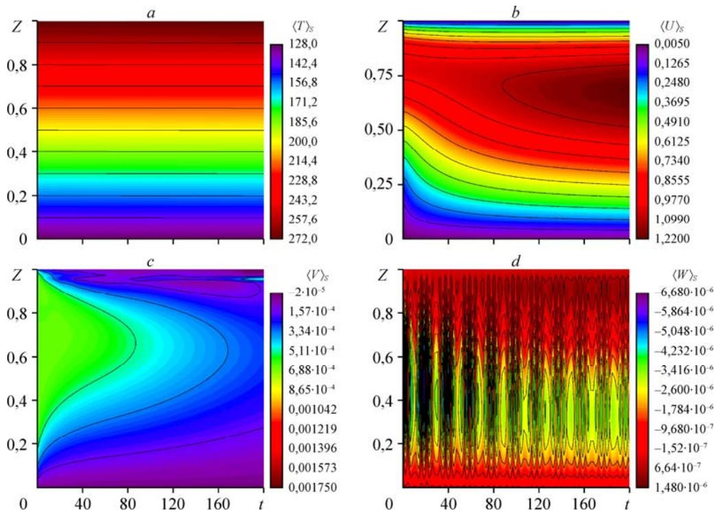
Рис. 8.  $Z$ - $t$ -диаграммы профилей температуры  $\langle T \rangle_s$  (a) и компонент скорости  $\langle U \rangle_s$  (b),  $\langle V \rangle_s$  (c),  $\langle W \rangle_s$  (d), построенные по результатам расчетов для  $Re_1 = 588$  на сетке  $64^3$ .
