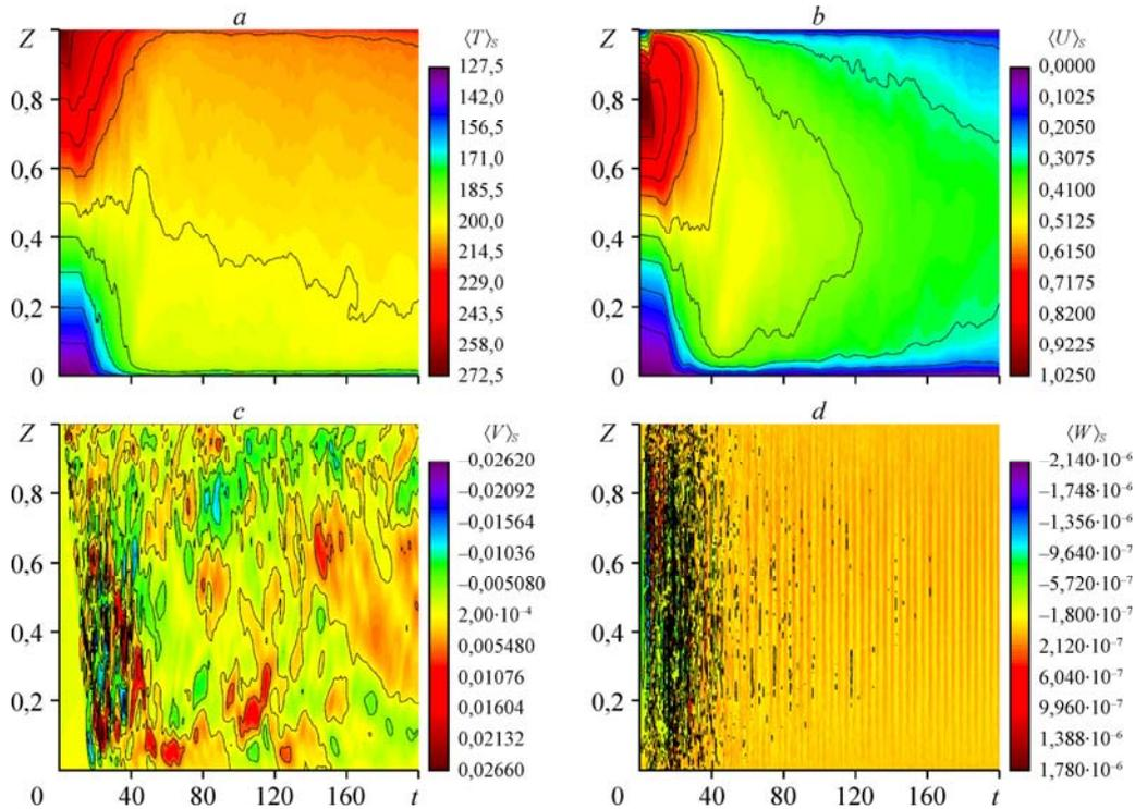
Рис. 10. Z-t-диаграммы профилей температуры  $\langle T \rangle_S$  (a) и компонент скорости  $\langle U \rangle_S$  (b),  $\langle V \rangle_S$  (c),  $\langle W \rangle_S$  (d) в случае турбулентного режима при числе Рейнольдса  $Re_1 = 4704$  на сетке  $128^3$ .
