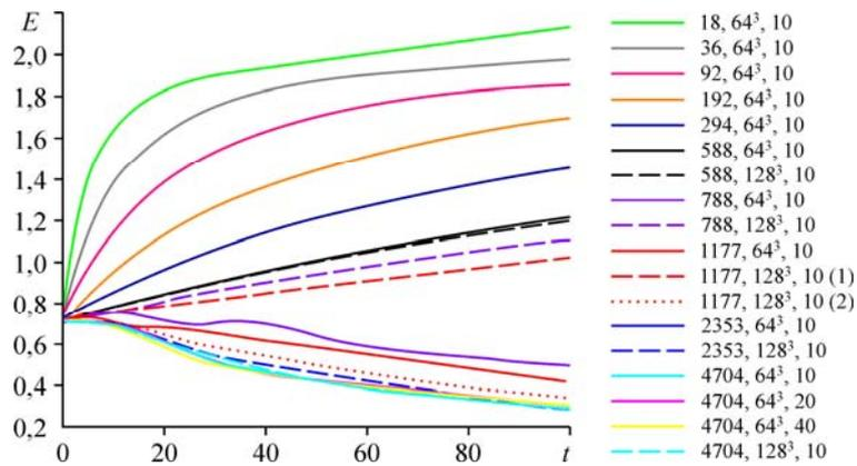
Рис. 6. Зависимость безразмерной кинетической энергии от времени, рассчитанная для различных чисел Рейнольдса на сетках  $64^3$  и  $128^3$ .
