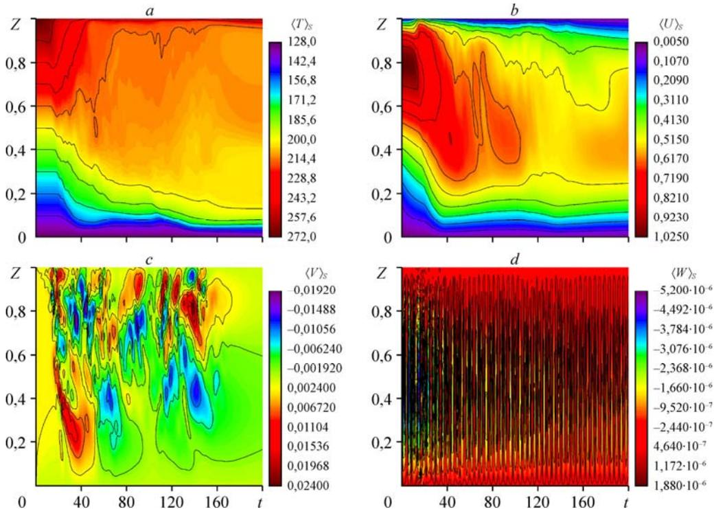
Рис. 9. Z-t-диаграммы профилей температуры  $\langle T \rangle_S$  (a) и компонент скорости  $\langle U \rangle_S$  (b),  $\langle V \rangle_S$  (c),  $\langle W \rangle_S$  (d) в случае турбулентного режима при низком числе Рейнольдса  $Re_1 = 788$  на сетке  $64^3$ .
