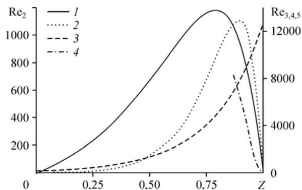
Рис. 2. Распределение безразмерных чисел Рейнольдса  $Re_2$  (1),  $Re_3$  (2),  $Re_4$  (3),  $Re_5$  (4) при среднемассовом  $Re_1 = 588$ .
