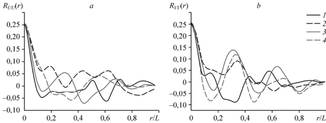
Рис. 3. Автокорреляционные функции  $R_{UU} = R_{UU}(r/L)$  (a) и  $R_{VV} = R_{VV}(r/L)$  (b) в направлениях  $X$  и  $Y$  соответственно для чисел Рейнольдса  $Re_1 = 588$  (1, 2), 788 (3, 4), рассчитанные на сетках  $64^3$  и  $128^3$ . Размер сетки  $64^3$  (1, 3),  $128^3$  (2, 4).
