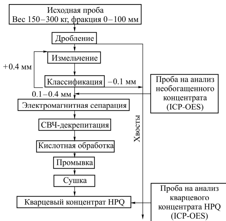
Рис. 1. Схема обогащения молочно-белого кварца Ларинского месторождения
