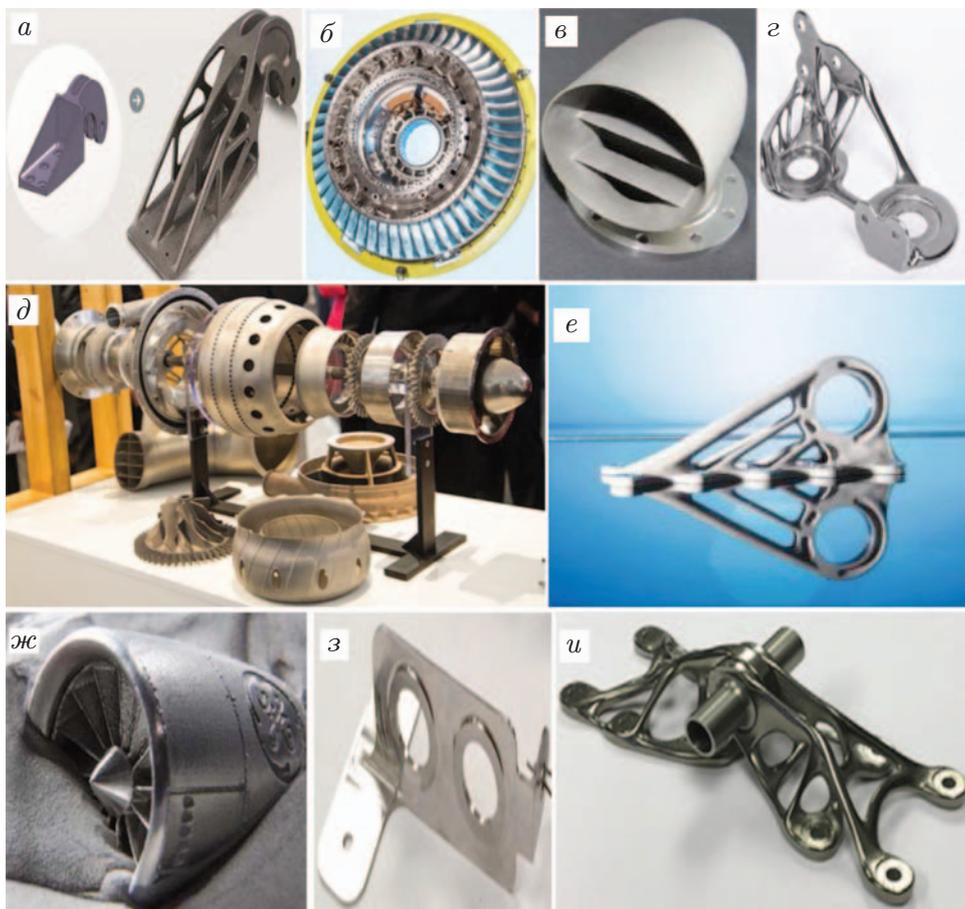
Рис. 4. Изделия для авиапромышленности, изготовленные методами АП:
