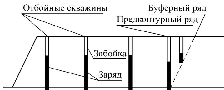
Рис. 1. Схема постановки (разрез) борта карьера (откоса уступа) скважинами переменной глубины, применяемая на карьерах ГРК “Быстринское”
