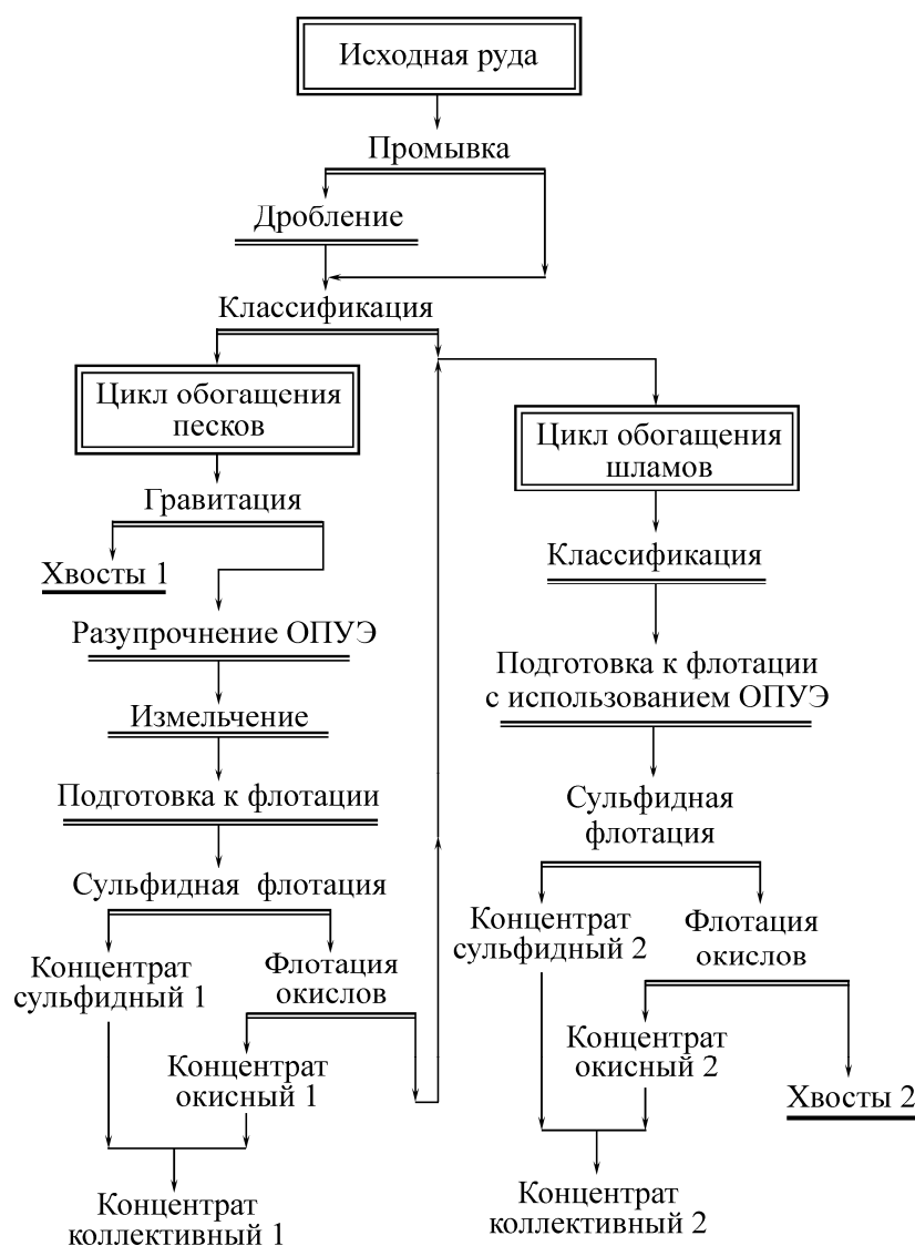
Рис. 2. Технологическая схема обогащения труднообогатимой Pb-Zn руды Жайремского месторождения с использованием обработки потоком ускоренных электронов (ОПУЭ)
