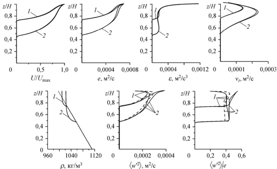
Рис. 2. Вертикальные распределения основных параметров на два момента времени, полученные с использованием модели  $M_{21}$  (тонкая сплошная линия),  $M_{22}$  (жирная сплошная линия) и  $M_{32}$  (пунктирная линия).
