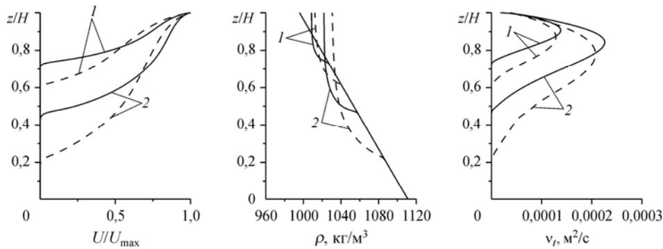
Рис. 3. Вертикальные распределения основных параметров течения по классической  $e-\epsilon$  модели (пунктирная линия) и модели 2.2 (сплошная линия). 60 (1), 240 (2) с.
