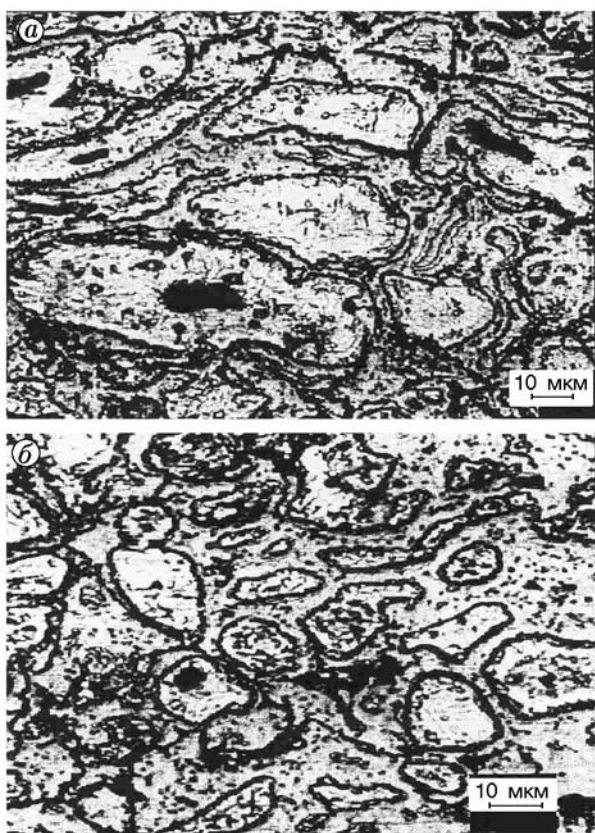
Рис. 3. Образец № 1. Микроструктура сплава, полученного методом теплового взрыва стехиометрической смеси Ti + Al
