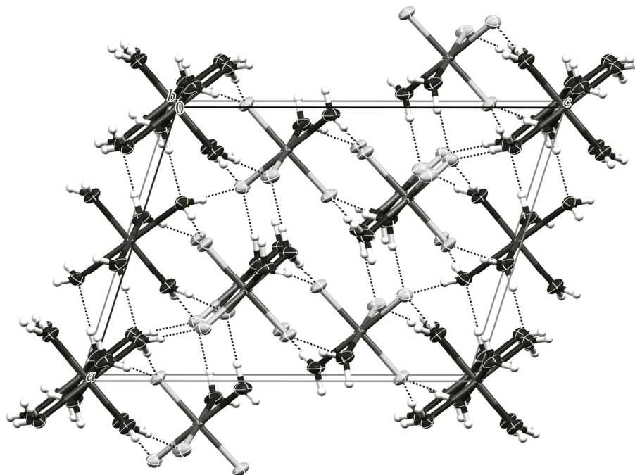
Рис. 2. Упаковка структурных единиц комплекса I в элементарной ячейке. Водородные связи показаны пунктирными линиями
