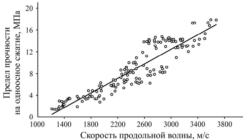
Рис. 2. Зависимость прочности на одноосное сжатие экспериментальных составов твердеющей закладки от скорости распространения продольной волны
