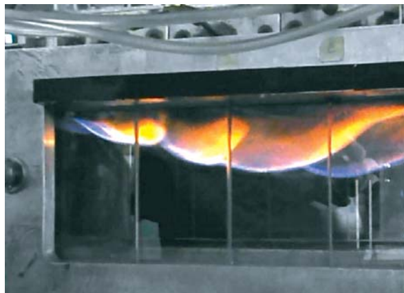
Рис. 1. Ячеистое пламя при горении испаряющегося этанола «на потолке» (воздушный поток слева направо)
