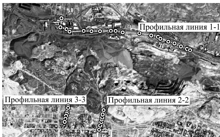
Рис. 5. План земной поверхности с профильными линиями: (1-1) — по простиранию рудного тела; (2-2) и (3-3) — вкрест простирания рудного тела
