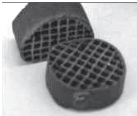
Рис. 2. Фотография фрагментов гибридного материала 12 % C/Ni/Bl-Al<sub>2</sub>O<sub>3</sub>.
