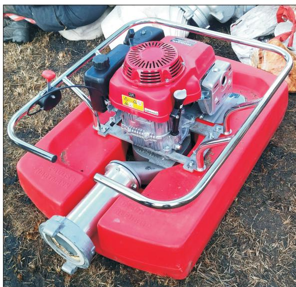
Рис. 7. Плавающая мотопомпа.
