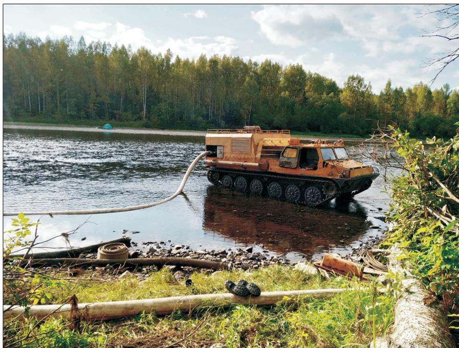
Рис. 6. Насосная станция на базе ГТ-ТМС.
