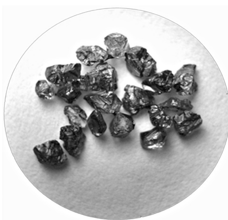
Рис. 4. Непрозрачные пленки на поверхности алмазов, извлеченных из хвостов РЛС доводочных операций
