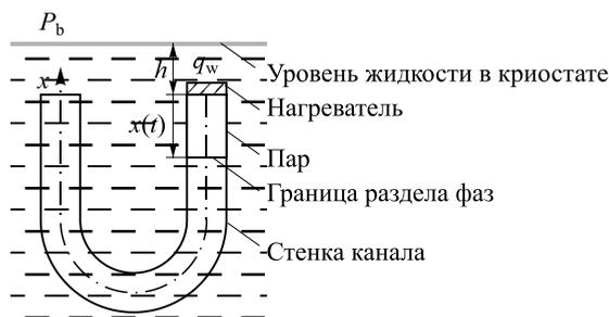
Рис. 1. Схема экспериментальной ячейки.
