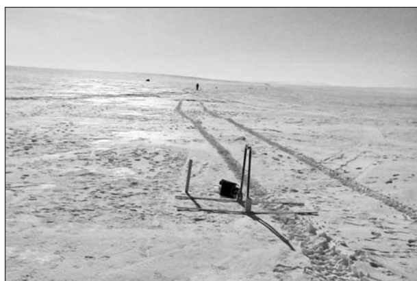
Рис. 2. Георадар ГРОТ 12Н с антенной 2 м (75 МГц).
