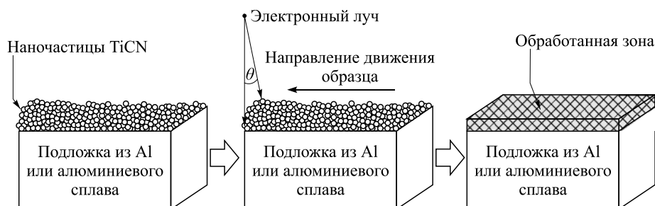
Рис. 1. Схематическое представление процесса обработки подложки электронным пучком.
