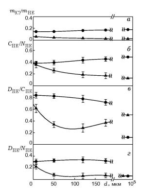
Зависимость состава конденсированных продуктов детонации компонентов смесевых ВВ от размера частиц ВВ:
