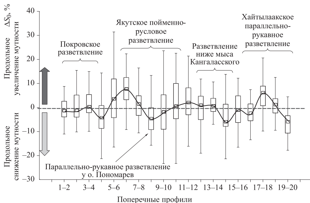
Рис. 2. Продольное изменение баланса мутности воды (диапазон без выбросов, среднее, стандартная ошибка (STD) и доверительный интервал 25–75 %) по длине р. Лены от г. Покровска до устья р. Алдан (створы см. рис. 1) (62 ситуации в период с 1992 по 2018 г.).
