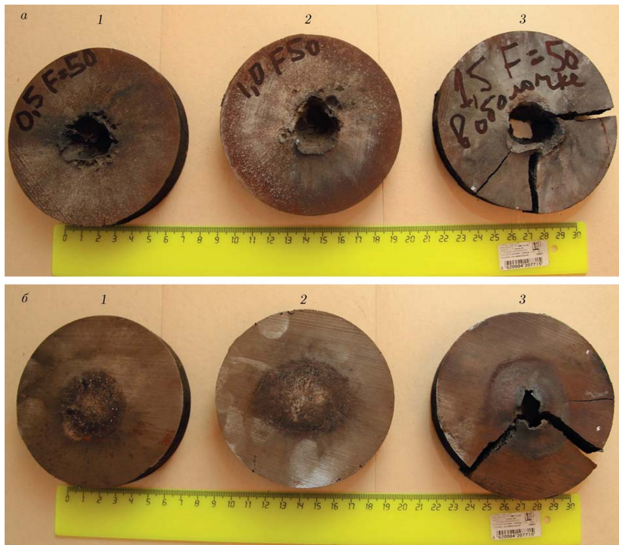
Рис. 2. Лицевая (а) и тыльная (б) стороны образцов-свидетелей, подвергнутых воздействию кумулятивных струй, сформированных из керамических трубок с толщиной стенки \delta = 0.5 (1), 1.0 (2), 1.5 мм (3)
