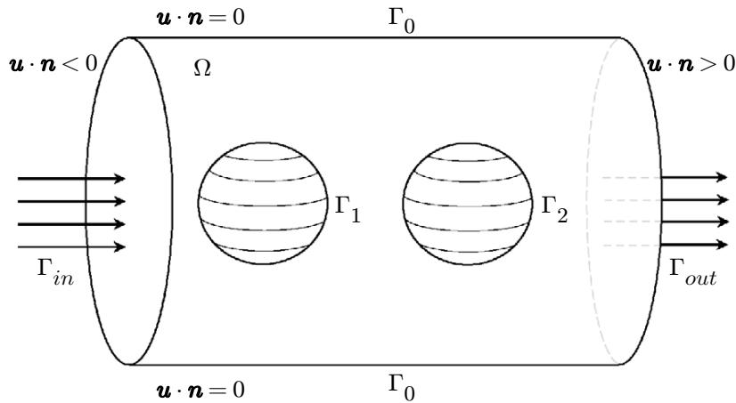
Геометрия области течения в случае цилиндрического канала с двумя препятствиями  $\Gamma_1$  и  $\Gamma_2$  внутри него при неоднородных граничных условиях для скорости и температуры на входе  $\Gamma_{in}$  и выходе  $\Gamma_{out}$
