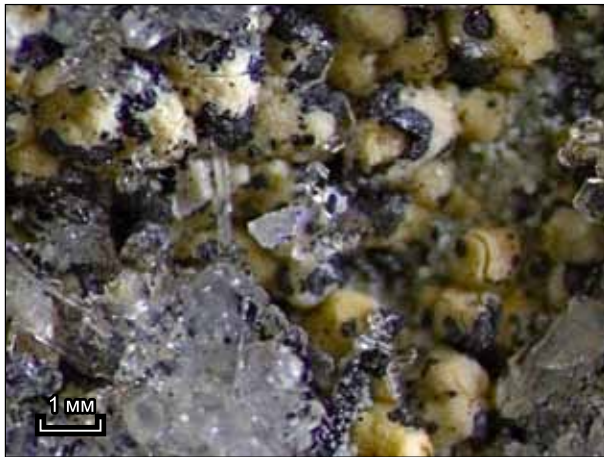
Рис. 15. Каверны флюидной деструкции в базальте, выполненные смектит-сидеритовыми новообразованиями и голландитовыми конденсатными корками (черное).
