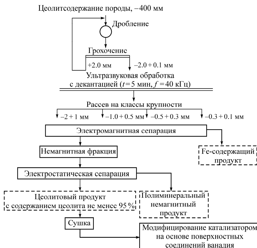
Схема обогащения и модифицирования цеолитсодержащих пород Шивыртуйского и Талан-Гозагорского месторождений
