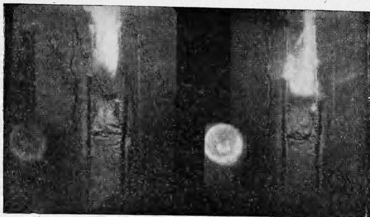
Рис. 4. Кинокадры горения смеси, снятые с интервалом 5 \cdot 10^{-2} сек. Видны мениски, конвективные токи в жидкости и колебание пламени, которое то приближается к жидкости, то отдалается от нее.
