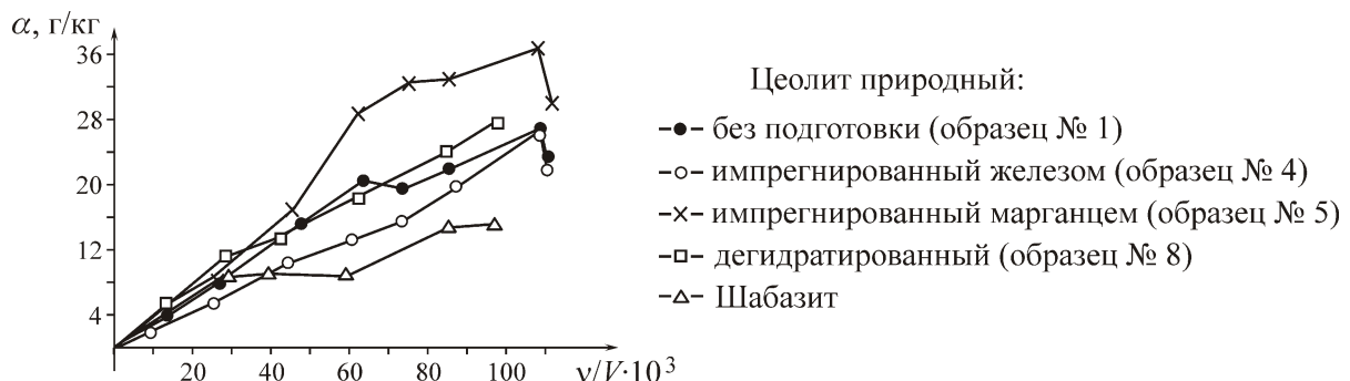
Рис. 3. Зависимость динамической емкости сорбентов от количества очищенного от окислов азота многокомпонентного газа (условия эксперимента: расход газа 120 л/ч; концентрация NO x исходная 0.2–1.8 г/нм 3 ; масса цеолита m 1 = m = 100 г, m 2 = 90 г, m 4 = 50 г)
