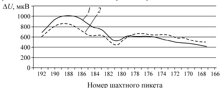
Рис. 3. Графики изменения \Delta U , построенные на основании полевых работ по вентиляционному штреку 21-1-11 после проведения противопожарных мероприятий: 1 — измерения по линии 2–2'; 2 — по линии 2'–2
