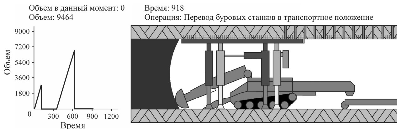
Рис. 7. Фрагмент анимации технологии скоростной проходки горных выработок
