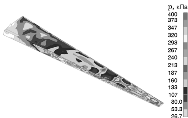
Рис. 7. Влияние взрыва ВВ массой 16 кг в тротиловом эквиваленте на структуру крыла
